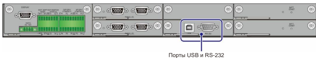
Рис. 4-12. Расположение портов USB и RS-232
