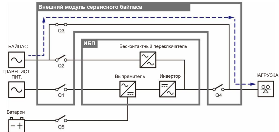
Рис. 3-4. Схема режима ручного байпаса
