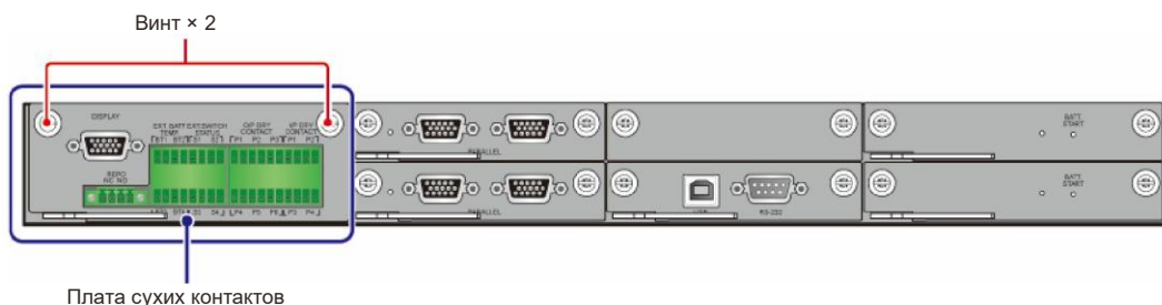
Рис. 4-3. Расположение платы сухих контактов
