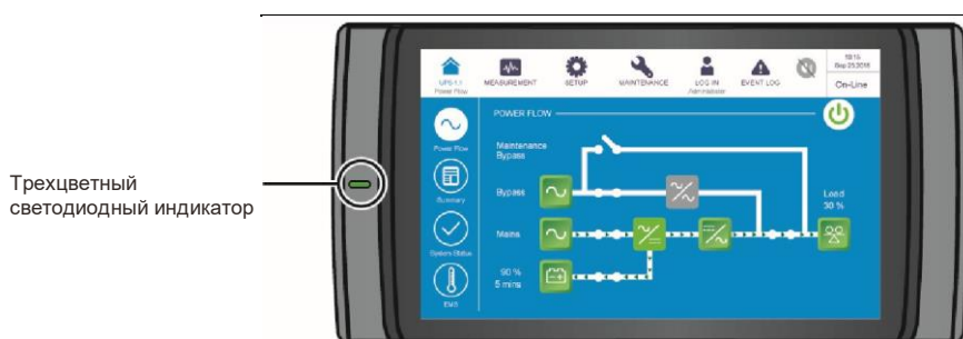
Рис. 2-17. Расположение трехцветного светодиодного индикатора
