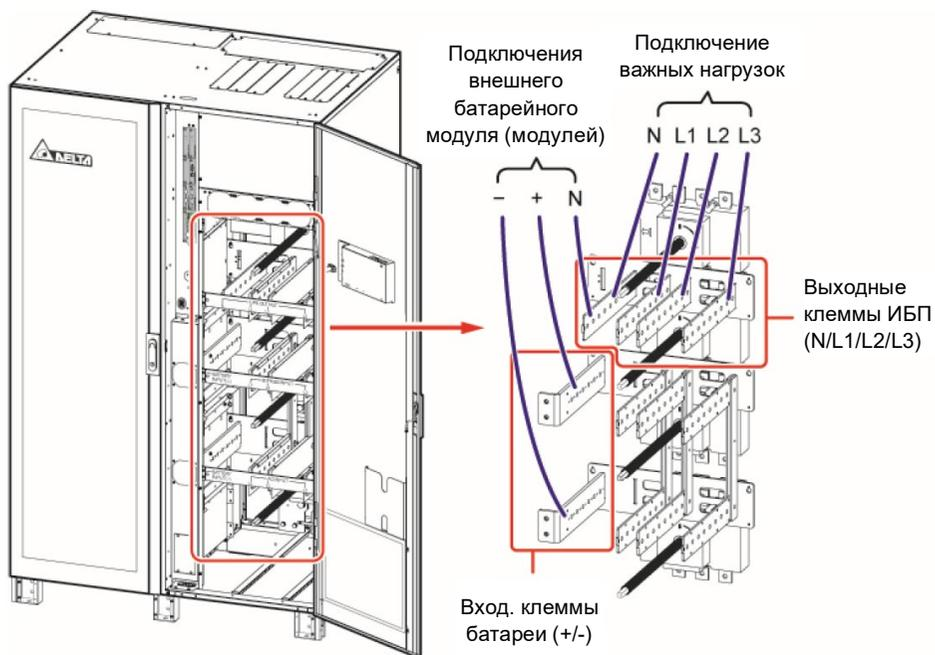
**Рис. 5-32: Схема верхнего подключения одного ИБП 400/500/600 кВА к двум линиям. Шаг 1**
