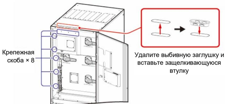
**Рис. 5-41: Прокладка параллельного кабеля ИБП 300 кВА, шаг 1**
