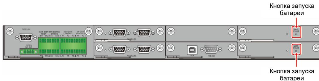
Рис. 4-19: Расположение кнопок запуска батарей
