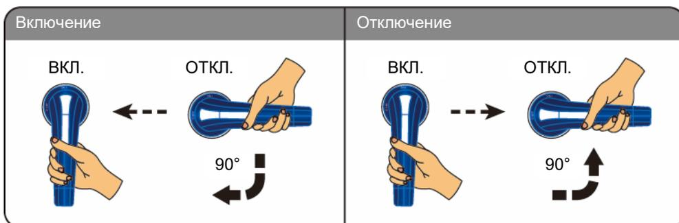
**Рис. 2-10: Включение/отключение выключателя**
